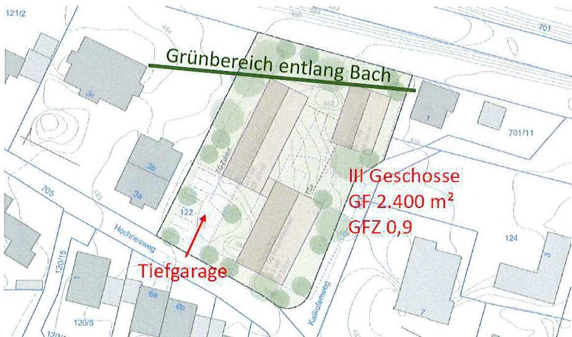
Abbildung 2: bauliche Rahmenbedingung mit möglicher Testplanung
